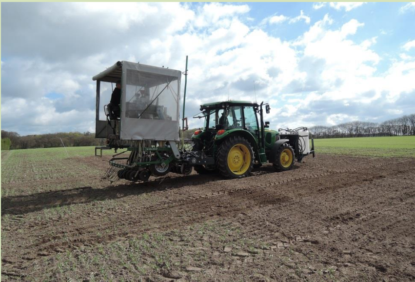
Såmaskine fra AgroTech til placering af flydende gødning
